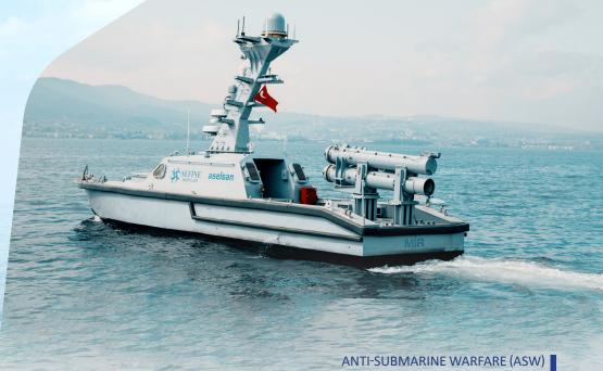
LIGHT WEIGHT TORPEDO & LAUNCHER SYSTEM (1X2, 2X2) SONOBUOY LAUNCHER & SIGNAL PROCESSING **AUTONOMOUS OPERATION** 35+ KTS SPEED HIGH MANEUVERABILITY INTEROPERABILITY AND FLEXIBILITY **HYBRID TASK ORGANIZATION & SWARM OPERATIONS** NETWORK CENTRIC/ENABLED OPERATIONS
