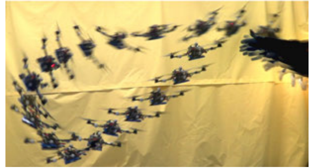
Şekil 2 – Elden atılan dört pervaneli robot helikopterin kendini stabilize etmesi
