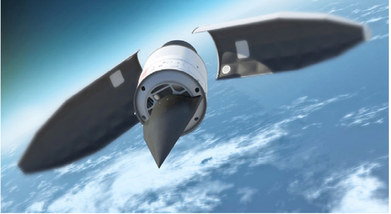
Şekil 6 – Uzayda kapsülünden ayrılmaya hazırlanan hipersonik manevralı süzülen tehdit
