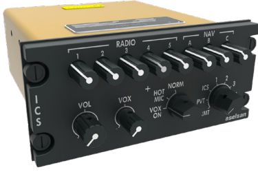
Haberleşme Sistemi Kontrol Birimi (HSKB)
