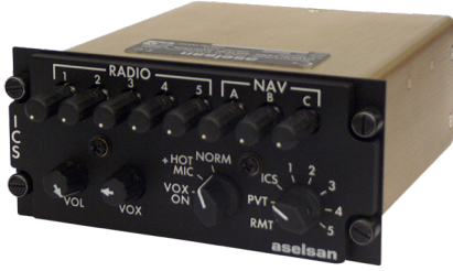
Haberleşme Sistemi Kontrol Birimi (HSKB)
