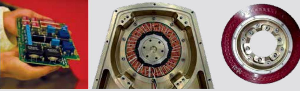
Şekil 3: HSY birimlerinde yerli olarak kullanılan servo denetleç, motor ve açı kodlayıcı çözümleri
