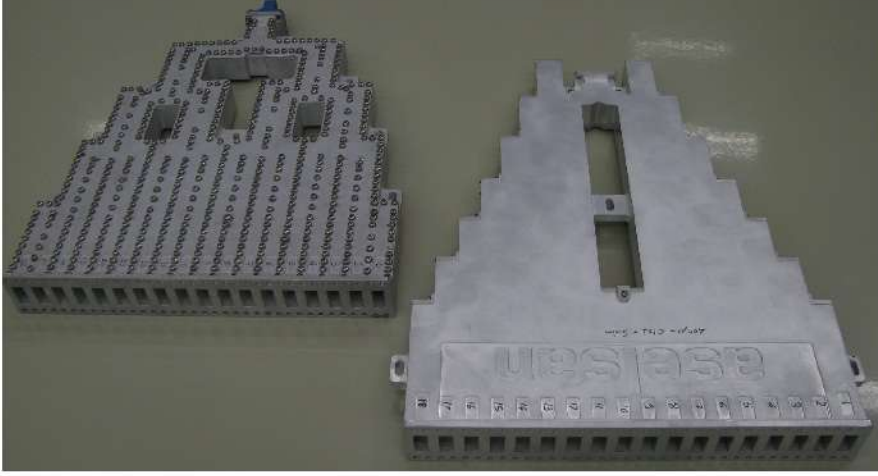
Resim 4. Vidalı ve Vakumlu Sert Lehimleme Yöntemiyle Üretilmiş Mikrodalga Güç Bölücüleri
