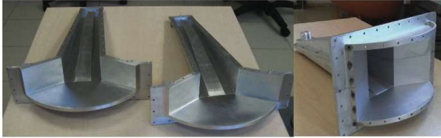
Resim 5. Vakumlu Sert Lehimleme Yöntemiyle Birleştirilmiş Boynuz Anten
