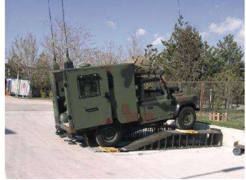
Şekil 14. Platform Ağırlık Merkezi Yüksekliği Tespiti
