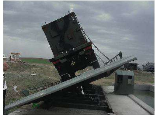
Şekil 16. Platform Arazi Testleri - Yan Eğim
