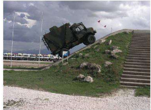
Şekil 15. Platform Arazi Testleri - Tırmanma
